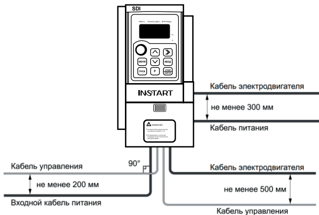
Рис. 3.6 Графическое представление расстояний между кабелями
