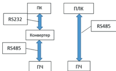
Рис. 7.1 Сетевой режим Master/Slave
